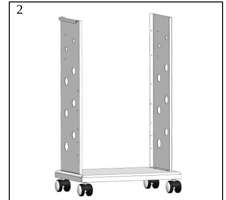
Стійки: гвинт М5, шайба М5, гайка М5.
